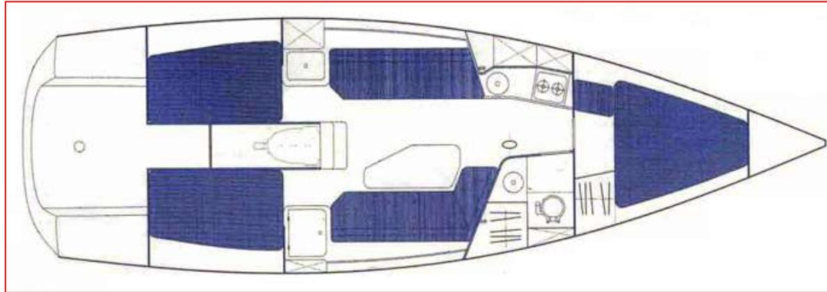
Questo modello è in grado di competere anche in regata. Il dislocamento è contenuto, grazie a un'accurata costruzione e a soluzioni per ridurre il più possibile ogni peso superfluo. La superficie velica è notevole e il bulbo pesca ben 2,45 m. Il pozzetto è ampio e sgombro, all'insegna della velocità di manovra, con le regolazioni della grande randa a poppavia del timoniere. Bompreso in carbonio e gennaker completano l'armo.
